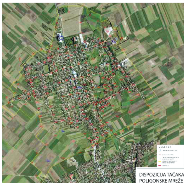
Слика 2. Диспозиција тачака полигонске мреже у размери 1 : 5000
